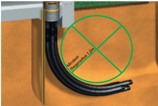
Abb. 3 und 3a, 3b: Mehrspartenhauseinführung für die Abdichtung der Gas-, Wasser-, Strom- und Telekommunikationsleitungen bei nicht unterkellerten Gebäuden.
